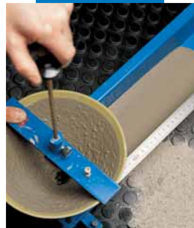
Испытание расширения в канавке согласно норме UNI 8997/89
