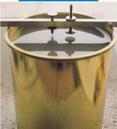
Определение свободного расширения в пластической фазе согласно норме UNI 8996/89
