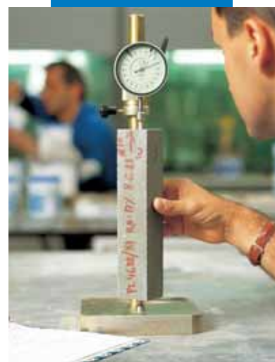
Определение расширения в стесненных условиях согласно норме UNI 8147/80
